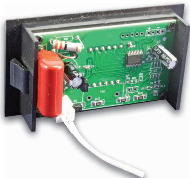
Рис. 2 – Вид сзади с подключенными входным сигналом и питанием
